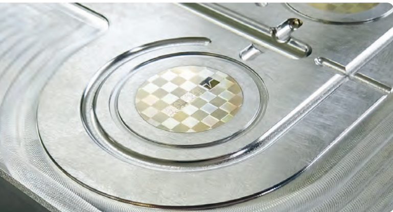
Gefrästes Hologramm – gut zu sehen, aber kaum zu fühlen. (Bild: Leonhardt)
