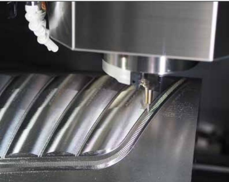
Experte für feinste Oberflächen: Blick in den Arbeitsraum eines iQ300-Bearbeitungszentrums von Makino. (© Hanser/Schröder)
