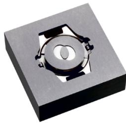
Das Bild zeigt eine erodierpolierte Kavität für das Spritzgießen von Uhrgehäusen.
